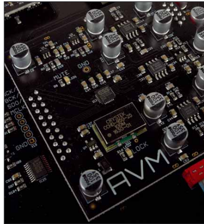
Die Wandlerplattform rund um den ESS-Chip ist austausch- und aufrüstbar
